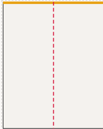
Regał Faro, strona A od lewej: IN-001, IN-002, LED 200 × 250 cm plik 203 × 253 cm, spad 1,5 cm po obrysie, łączeń: 1
