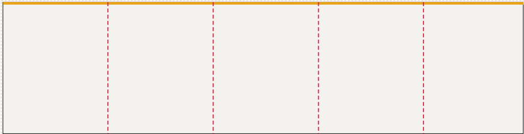
Ściana tylna od lewej: FR-001 ... FR-005, LED 991 × 250 cm plik 994 × 253 cm, spad 1,5 cm po obrysie, łączęń: 4
