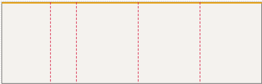
Ściana tylna od lewej: FR-001 ... FR-005, LED 801 × 250 cm plik 804 × 253 cm, spad 1,5 cm po obrysie, łączeń: 4
