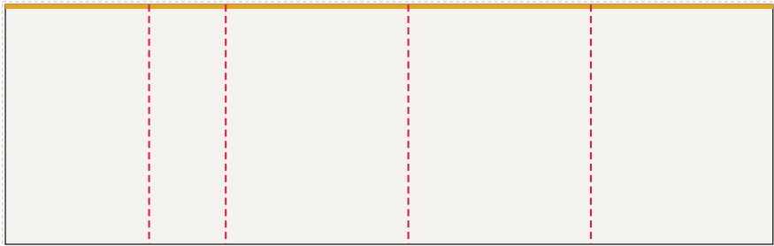
Ściana tylna od lewej: FR-001 ... FR-005, LED 801 × 250 cm plik 804 × 253 cm, spad 1,5 cm po obrysie, łączni: 4
