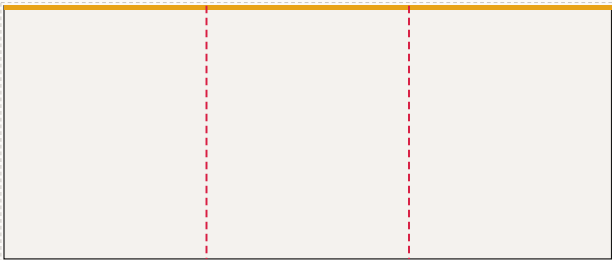
Ściana tylna od lewej: FR-001 ..., FR-003, LED 600 × 250 cm plik 603 × 253 cm, spad 1,5 cm po obrysie, łączeń: 2
