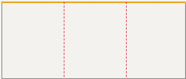
Ściana tylna od lewej: FR-001 ..., FR-003, LED 590 × 250 cm plik 593 × 253 cm, spad 1,5 cm po obrysie, łączeń: 2
