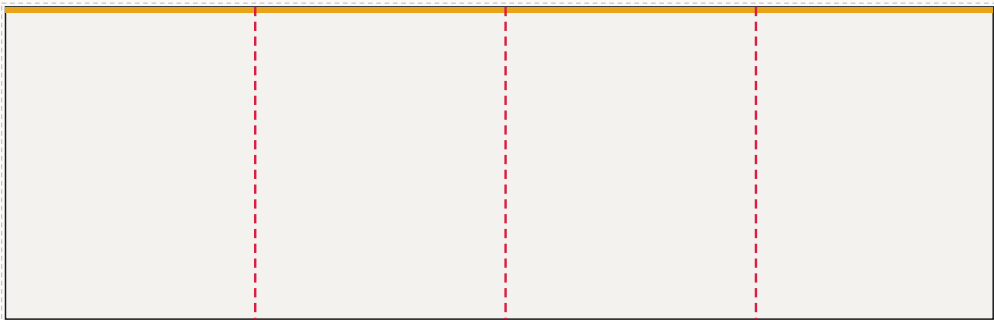
Ściana tylna od lewej: FR-001 ... FR-004, LED 791 × 250 cm plik 794 × 253 cm, spad 1,5 cm po obrysie, łączęć: 3
