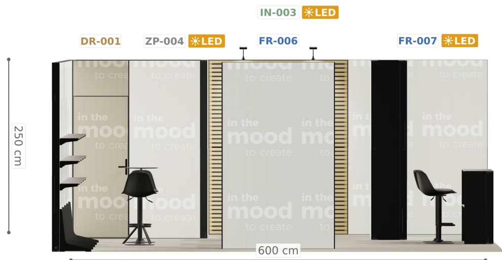
Elewacja ściany prawej
