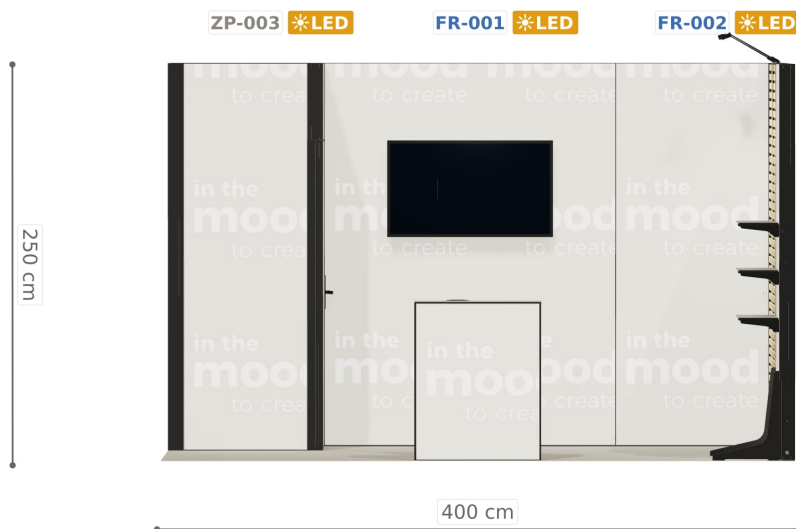
Elewacja ściany tylnej
